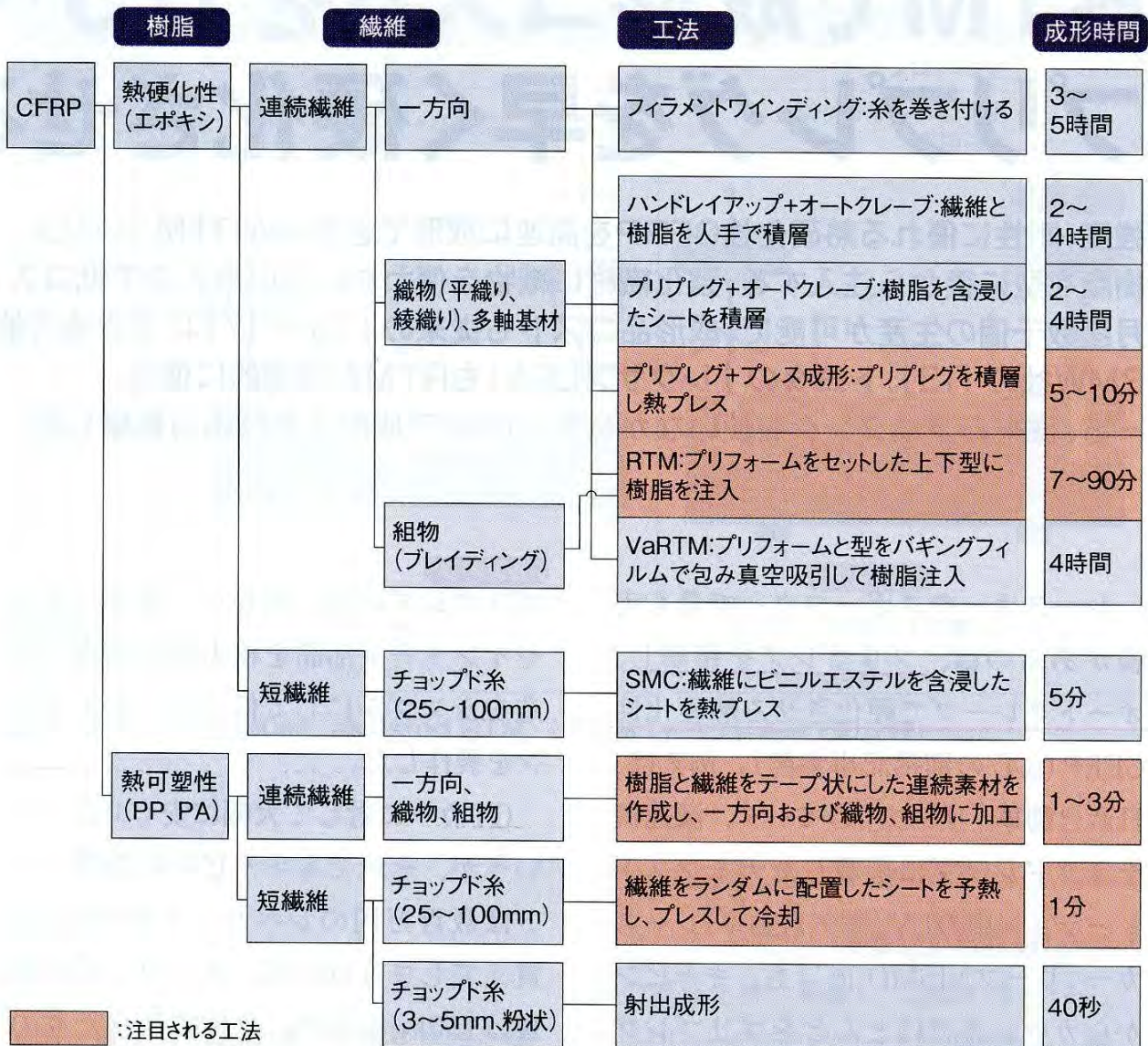
図 35 CFRP の種類と工法 Automobile Technology より (23)
